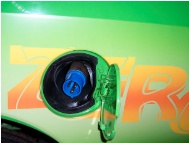
Steckdose für die Ladung in der Tankklappe
